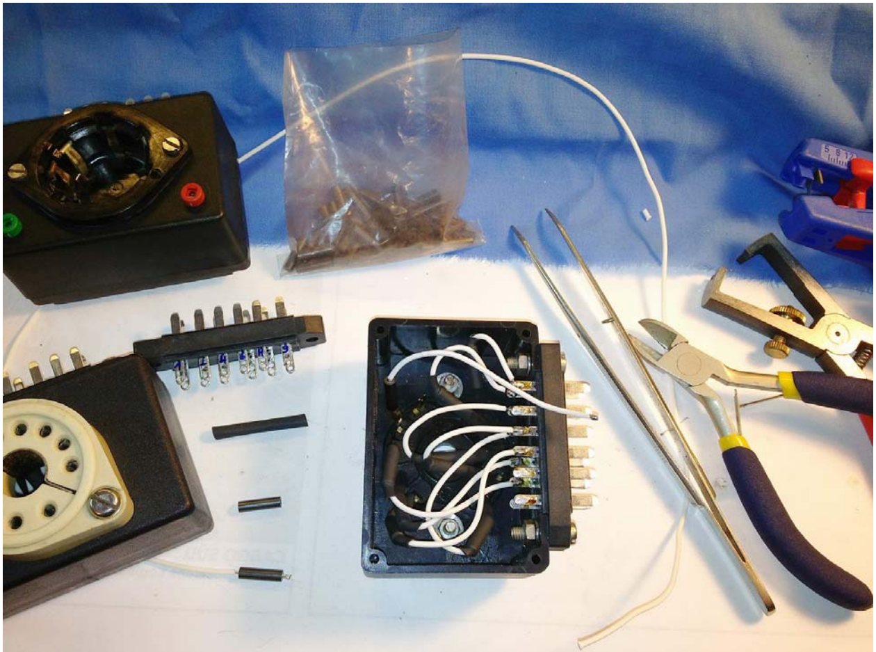
Fassungsboxen beim Zusammenbau. Teflonisierte Drähte, Ferrithülsen im Schrumpfschlauch
