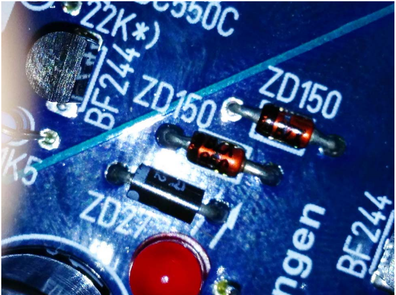
Bestückungsaufdruck v6.2 unterscheidete sich geringfügig von Stückliste / Bauteilbestellung
