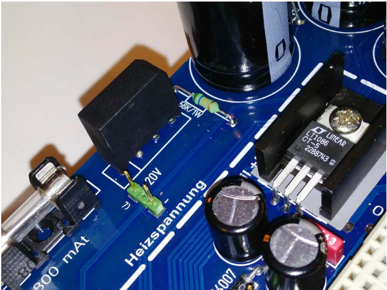
Bestückungsaufdruck v6.2: Das (+) Zeichen beim Gleichrichter ist an der richtigen Stelle. Auch im Bild: Prüfstifte.
