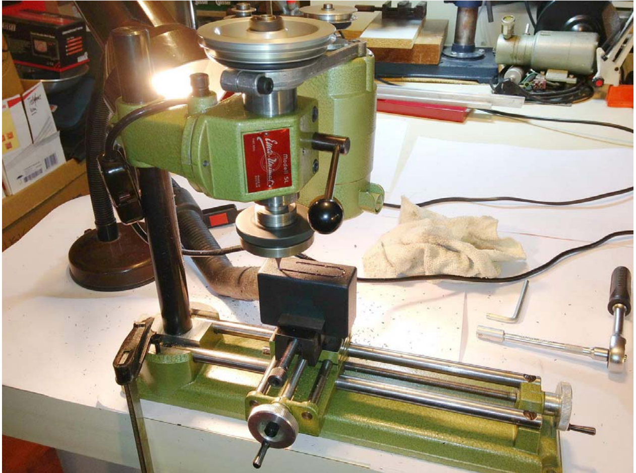
Fräsen der Ausnehmung für die Messerleiste in der Fassungsanschlussbox
