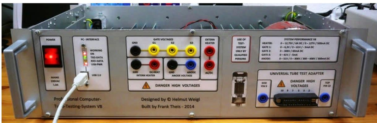
Gut zu erkennen auch der zusätzliche Block mit den Spannungsbuchsen für die Röhrenexperimente, das funktioniert mit diesem Gerät extrem gut, auch weil alles toll überwacht und geschützt ausgegeben wird mit zusätzlicher Messfunktion am PC, wie ein Röhrennetzteil mit extremem Luxus.
