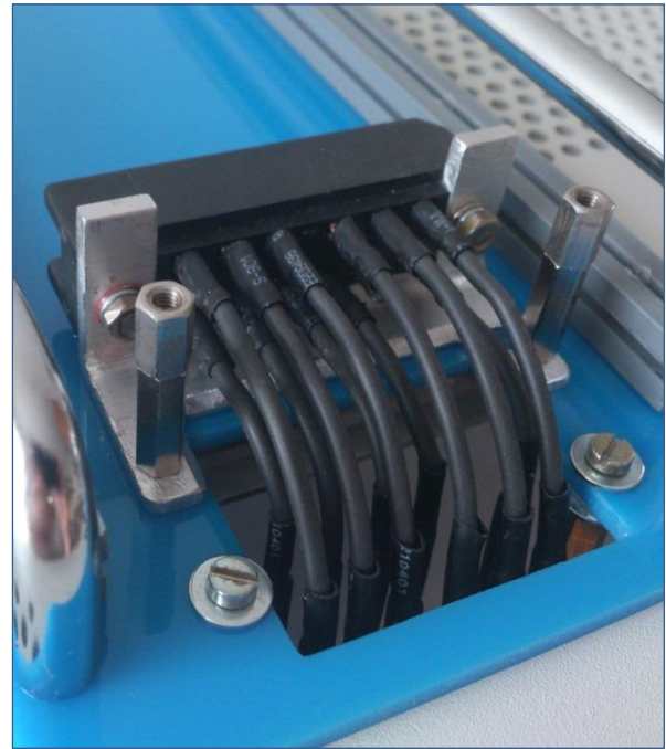
Ferrithülsen in sämtlichen Leitungen
