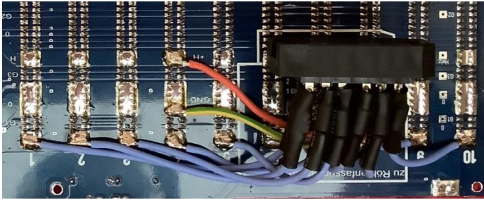
Abbildung 12: Verkabelung Anschlussbox Leiterplatte
