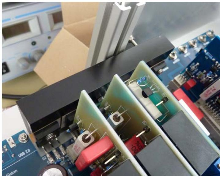
Alle Seitenteile müssen geerdet werden, da diese nur auf der Front- und Bodenplatte aufliegen und das Einfassprofil aus Kunststoff ist.
