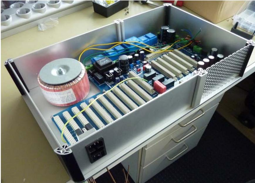
Die Abdeckung über der Buchsenleiste ist nur gesteckt. Die Befestigungslöcher des Kunststoffgehäuses wurden nur mit 3mm aufgebohrt und die Schrauben von unten durch die Frontplatte geschraubt.
