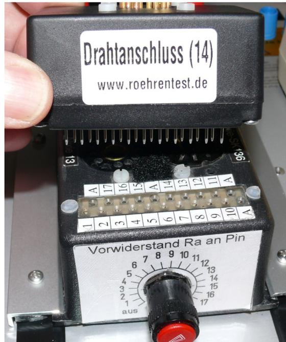
Bei anderen Röhren ist ein Direktanschluss an das RoeTest notwendig. Dafür habe ich mir einen Adapter gebaut. Die Pins 1-10 sind direkt zum RoeTest-Steckverbinder geführt. Die Pins 11-14 sind an Buchsen herausgeführt. Schleift man zwischen Adapterbox und RoeTest noch die Inserterbox ein, kann man die Anschlüsse beliebig patchen (ist vor allem für VFD's notwendig).
