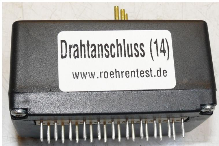
Es gibt etliche Röhren mit Drahtanschluss (vor allem Nixies, VFD's). Nun kam ich endlich dazu die Idee von Bernd Holzauer nachzuvollziehen. Die selbstgebaute Fassung besteht aus Messingröhrchen mit Aussendurchmesser von 2 mm, welche in zwei übereinanderliegende, gleiche Leiterplatten eingelötet werden. Dabei haben die Röhrchen unterschiedliche Längen.
